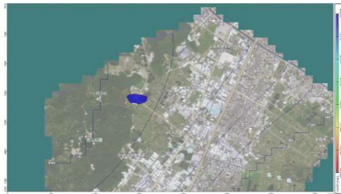
图 5.4-5 废水处理站调节池底部防渗系统破裂废水泄露 COD 泄露 365 天预测图
