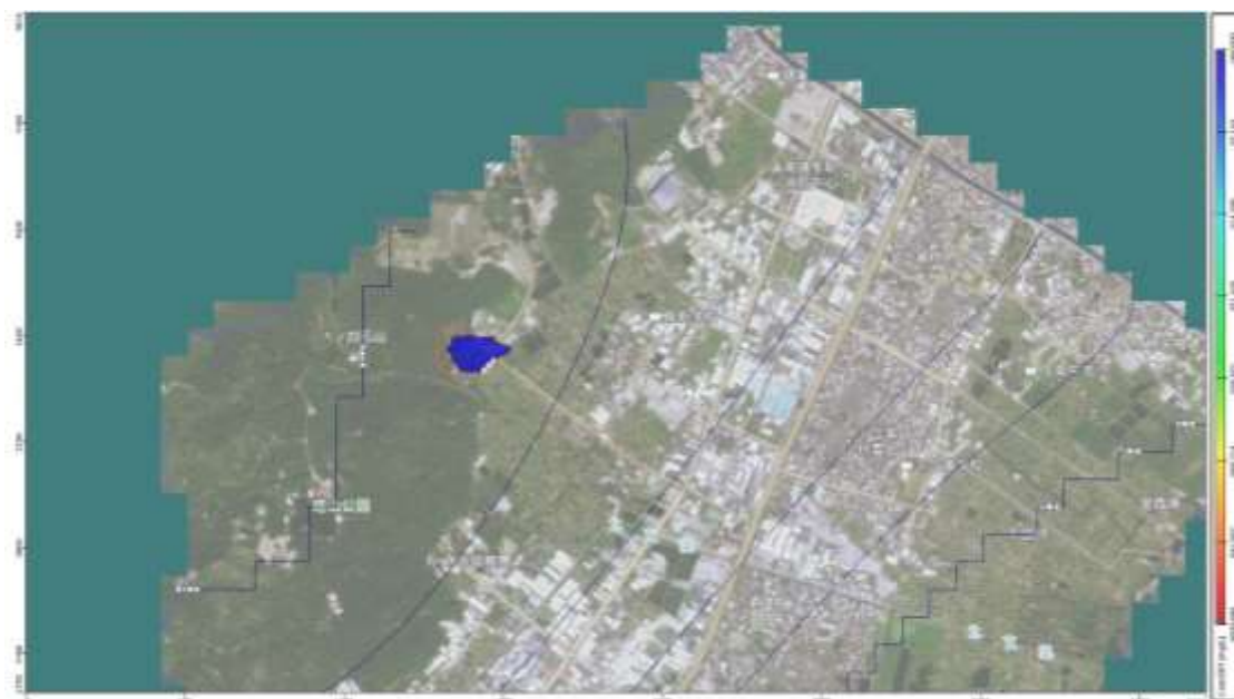
图 5.4-4 废水处理站调节池底部防渗系统破裂废水泄露 COD 泄露 90 天预测图
