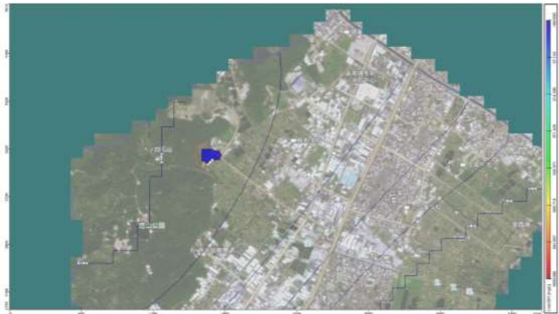
图 5.4-3 废水处理站调节池底部防渗系统破裂废水泄露 COD 泄露 30 天预测图
