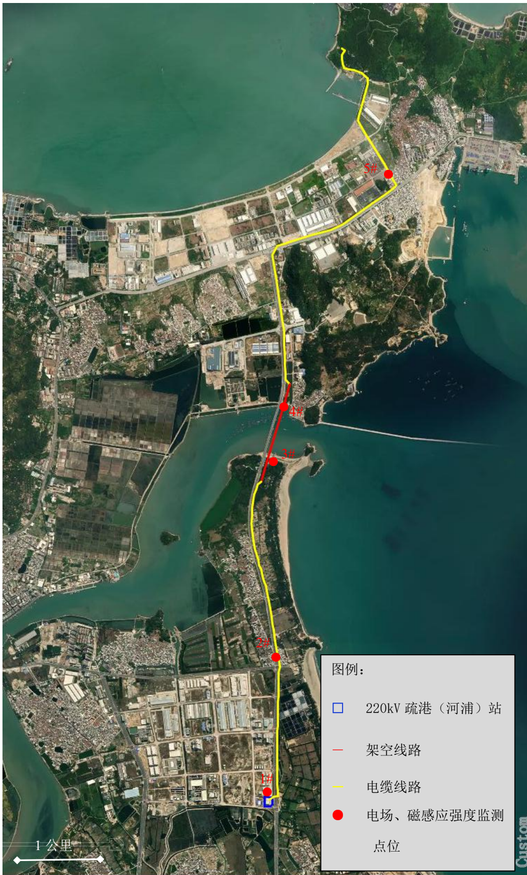
图 7-1 本项目电场、磁感应强度监测布点示意图
