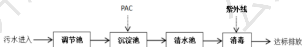
图 4-1 污水处理设施处理工艺流程图
